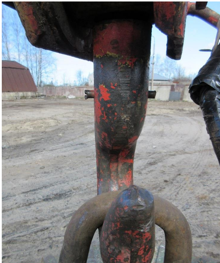
Kravas celtnim bojāts kāša drošības aizslēgs
