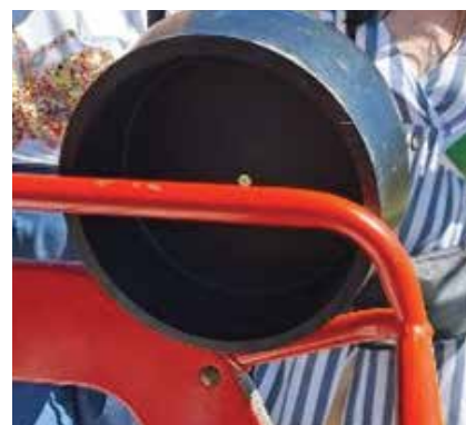
104., 105., 106.attēls. Balansieri. Galvas iesprūšanas risks iekārtas konstrukcijas elementos.
