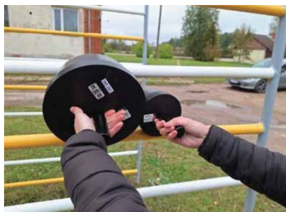
97., 98.attēls. Kompleksā iekārta. Iekārtas konstrukcijas elementos pastāv galvas iesprūšanas risks (viegli pieejami iekārtas elementi), nedrošas konstrukcijas slīdkalniņš (nav šķērsstienis, nav nobeiguma daļas, slīdēšanas virsmā atvērumi), slīdkalniņa ietekmes zonā betona celiņš (neatbilstošs triecienu mazinošais segums).
